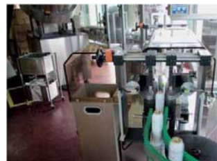
检重秤可水平和侧向调整的输出和输入皮带，可加速传递喷雾罐
