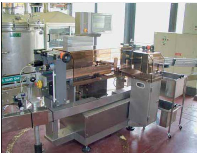
带侧向导轨皮带的 EWK2000PLUS 检重秤，称量气溶胶喷雾罐
