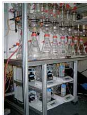
赛多利斯公司的实验室天平已经成功地与 ALGOCHEM 公司的蒸馏过程相结合。
