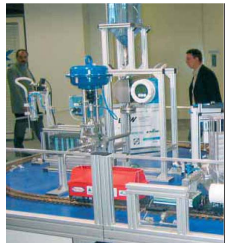
全微缩模型工厂 — 装有赛多利斯公司的紧凑型传感器、平台、Profibus 变送器和称重指示器。
