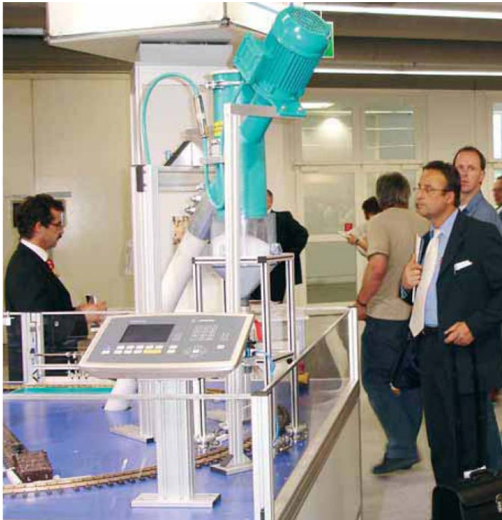
PR 6211 型紧凑型传感器用于出自筒仓的颗粒状物质加载
