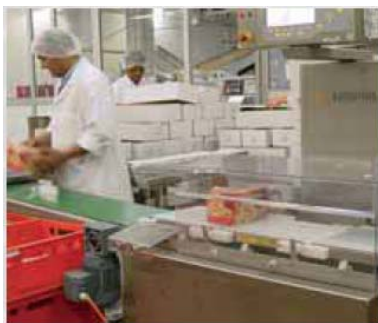
用 EWK3000 检重秤对长棍进行最后的质量控制
