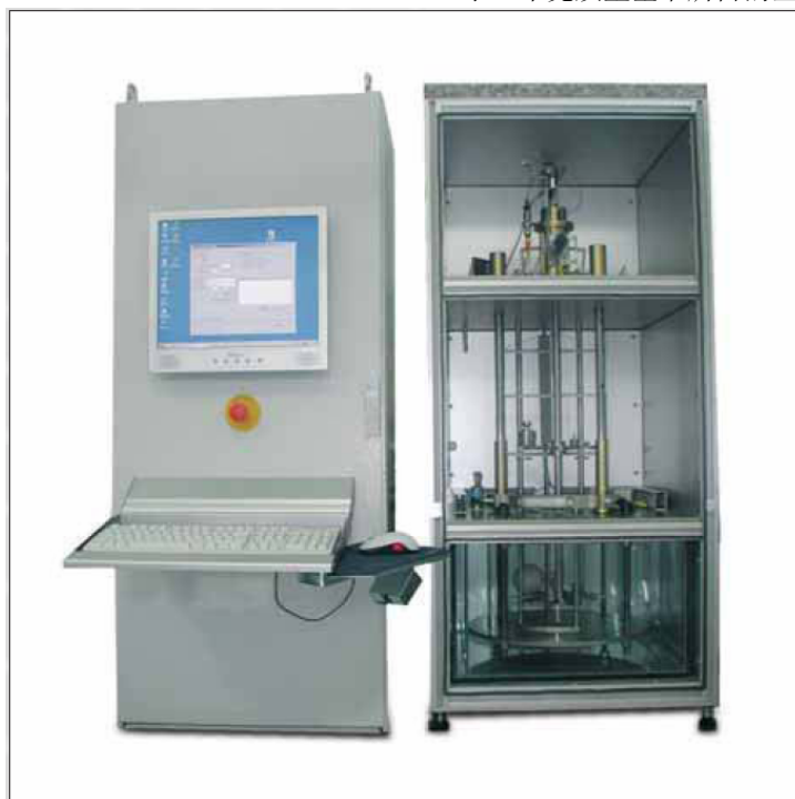
图 1 BEV 的 VD1005 体积质量比较仪
