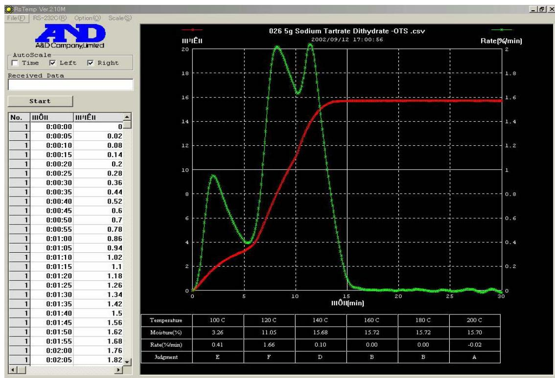
RsTemp 是“加热温度确定软件”，在使用 MX-50 和 MF-50 测定含水率时，用来确定最佳加热温度。
