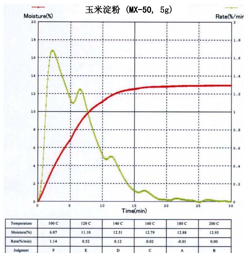
例 2：测定的含水率曲线在某一个加热温度点以上出现明显的向上倾斜。
