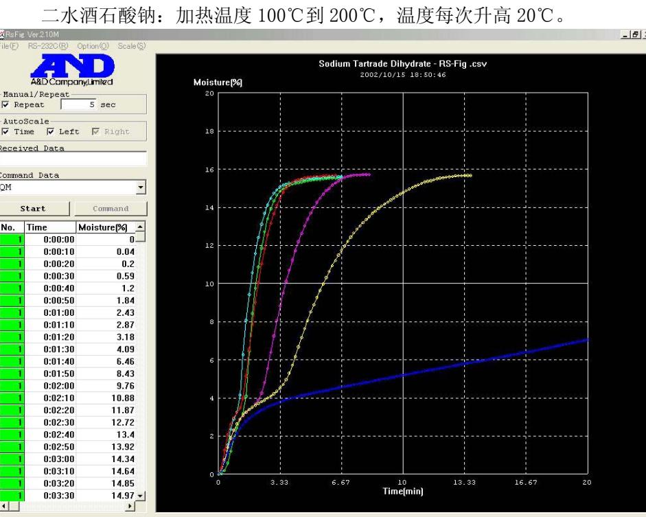
二水酒石酸钠：在 160°C 加热温度下测定 5 次。所有 5 条含水率曲线相互重叠在一起，证明 MX/MF-50 的重现性良好。
