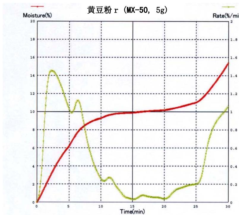
此图是黄豆粉测定的显示结果,下图是奶油花生的显示结果。
