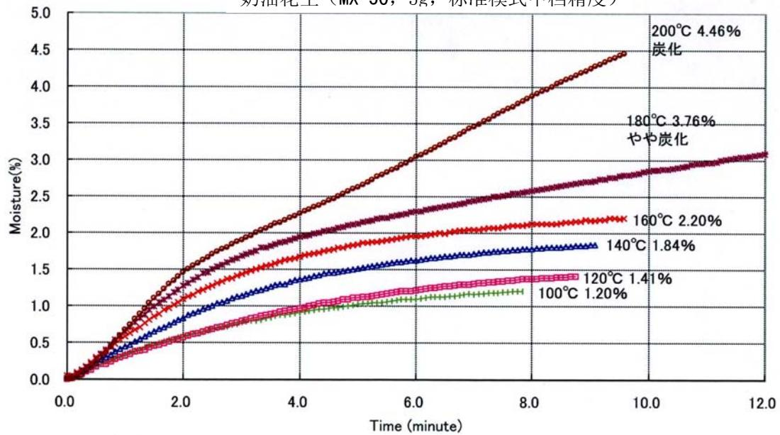
例 3：通过改变加热温度不能确定稳定的加热温度
