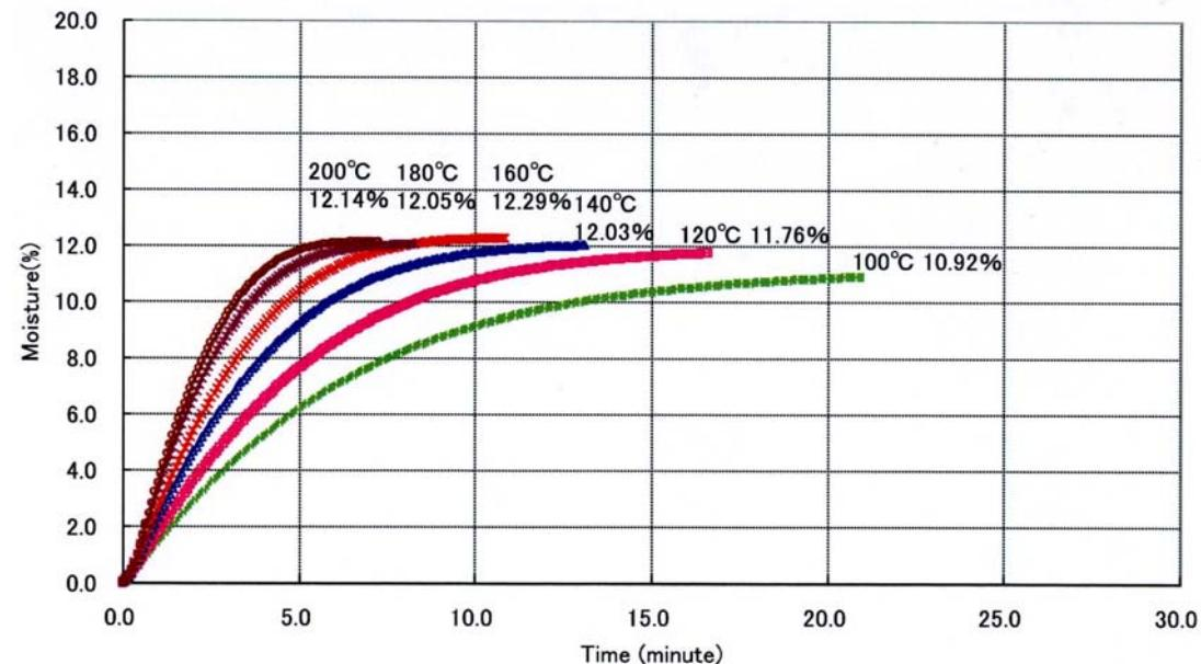
例 2：测定的含水率曲线在某一个加热温度点以上出现明显的向上倾斜。
