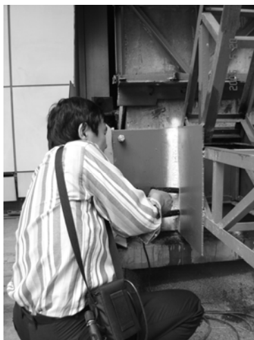
图4 技术人员进行焊缝磁粉探伤
